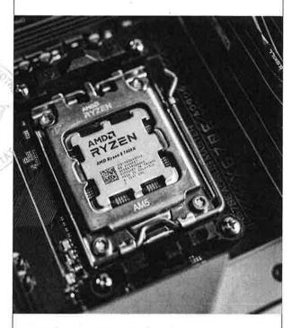
Die neuen Ryzen-7000-CPUs mit sechs bis sechzehn Kernen sind dank neuer AM5-Mainboards, schnellem DDR5-RAM und mehr Leistungsbudget viel schneller als Intels Core i-12000.
